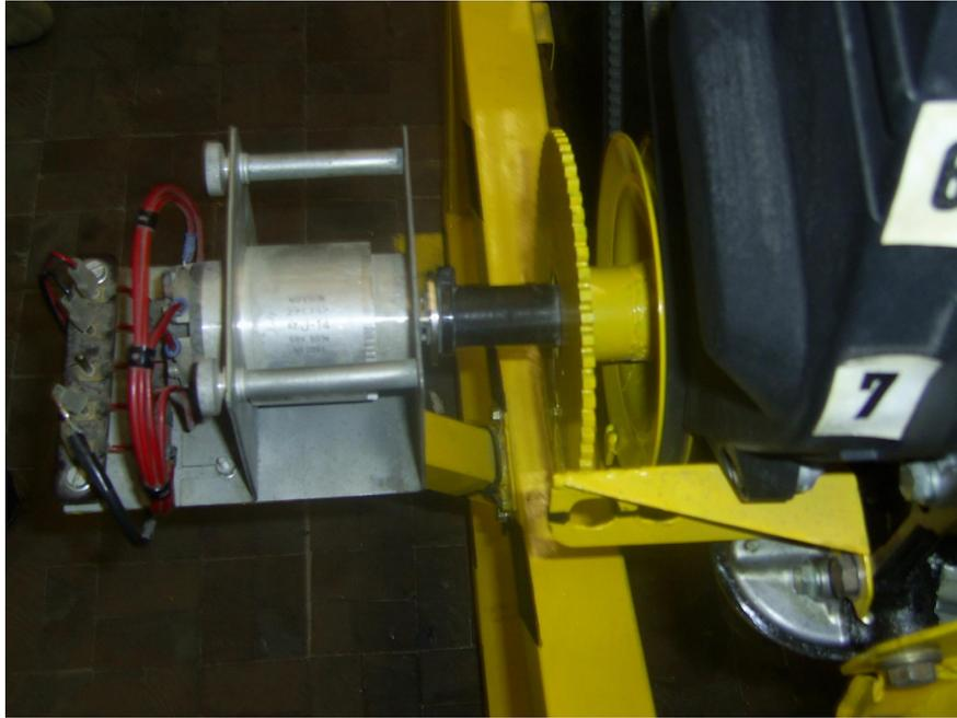
Alternador acoplado al cigüeñal
