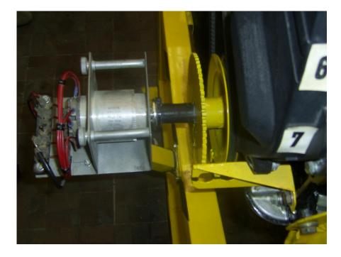
Alternador acoplado al cigüeñal
